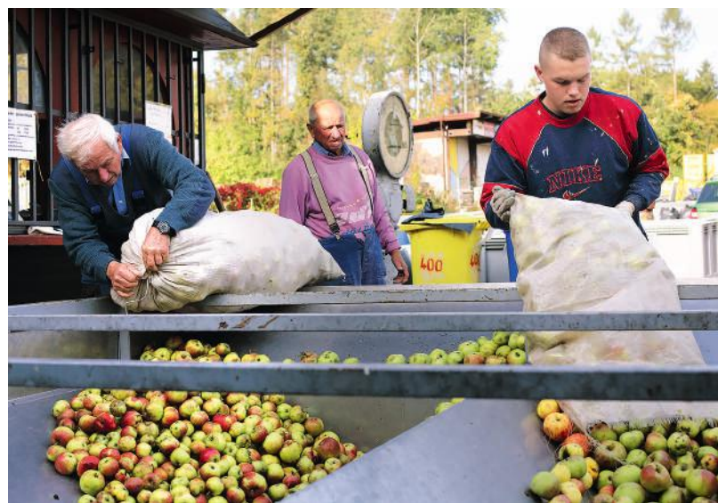
Ovoce dovezené do palírny se nejprve musí zvážít. Pak se vysype do zásobníků, odkud putuje do myčky
